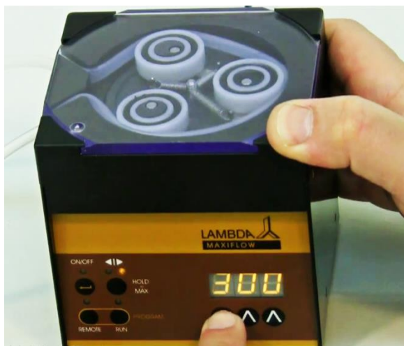
Obrázek 1-11 Tlačítka \wedge \wedge \wedge lze použít pro nastavení požadovaného průtoku.
