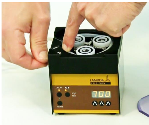
Obrázek 1-8 Vtlačíme hadičku do přední drážky dle obrázku.
