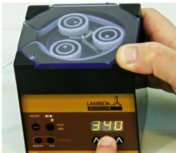
Obrázek 1-12 Každé z tlačítek \wedge \wedge \wedge lze použít ke změně číslce k nastavení odpovídajícího průtoku.
