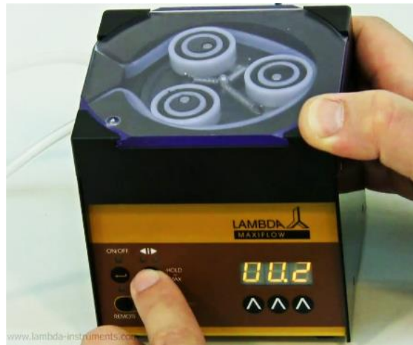
Obrázek 2-8 Stisknutím tlačítka ◀▶, lze měnit časové rozlišení a to buď v minutách, nebo v 0,1 minut. V případě rozlišení v desetínách minut se zobrazí na displeji tečka např. "00.1". Časové rozlišení lze nastavit jednotlivě pro každý krok programu.
