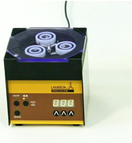
Obrázek 1-2 Zapojte napájecí zdroj do elektrické sítě (90-264V/50-60 Hz). Po krátkém zvukovém signálu se rozsvítí displej, na kterém se objeví předchozí posledně použité nastavení.
