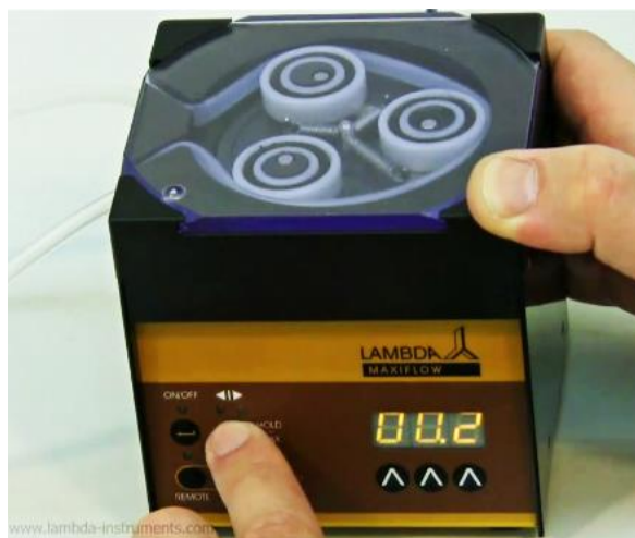
Obrázek 2-14 Stiskněte tlačítko ◀▶ pro volbu časového rozlišení.
