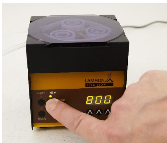
Obrázek 1-13 Svítící LED dioda pod symbolem ◀| reprezentuje otáčení ve směru hodinových ručiček.
