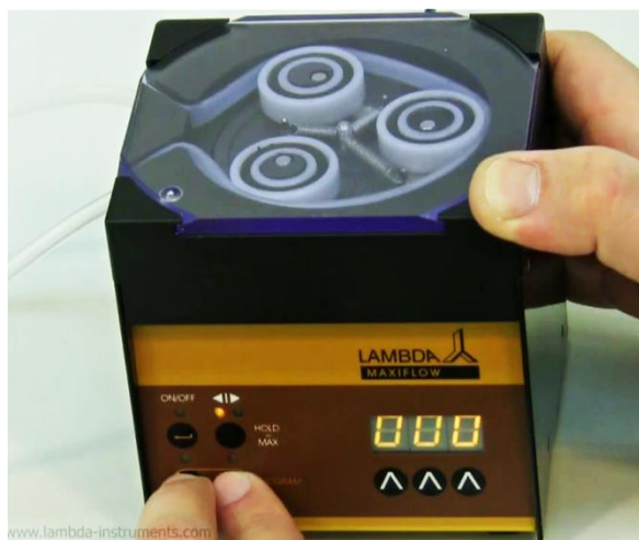
Obrázek 2-16 Na displeji se zobrazí průtok 000 následujícího kroku, který však už nemáme v
