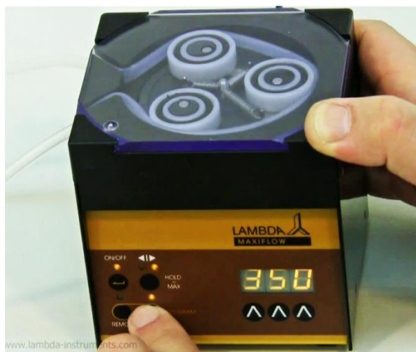
Obrázek 2-20 Chcete-li spustit program, stiskněte tlačítko RUN . Program běží, svítí LED dioda RUN a ON/OFF .
