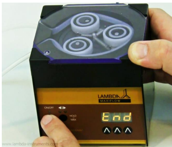
Obrázek 2-19 Stiskněte tlačítko ON/OFF a vyčkejte, až se na displeji zobrazí “End”. Nyní je program uložen.
