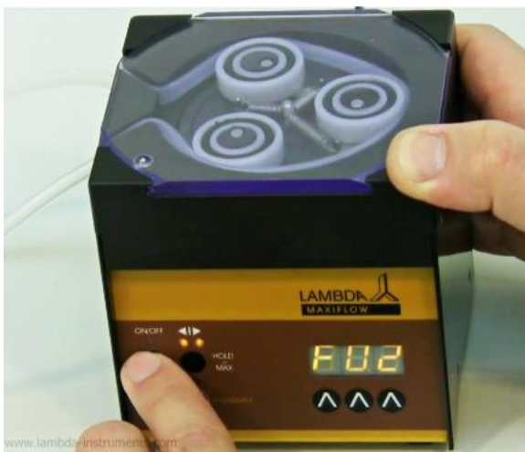
Obrázek 2-9 Stiskněte tlačítko ON/OFF. Na displeji se krátce zobrazí označení "F02" a můžeme začít s nastavením druhého kroku programu.
