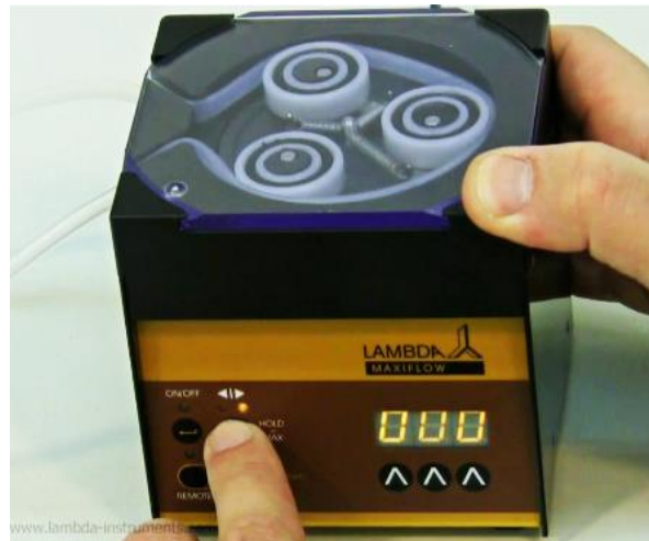
Obrázek 2-4 Nejprve zvolte směr otáčení pomocí směrového tlačítka \leftarrow\rightarrow .
