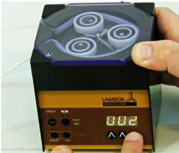
Obrázek 2-7 Nastavte požadovaný časový úsek pro první krok programu pomocí tlačítek ▲▲▲ pod displejem (v rozlišení: 0–999 min. nebo 00.0–99.9 min.).
