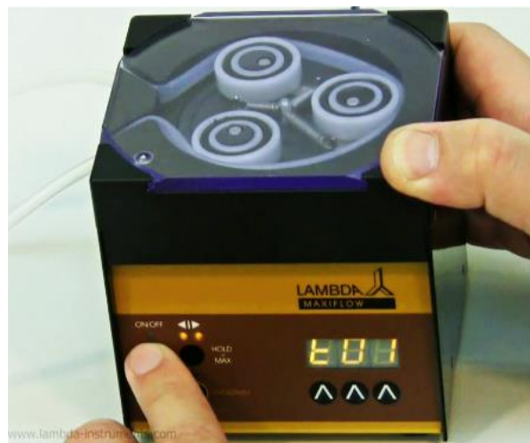
Obrázek 2-6 Pro potvrzení stiskněte tlačítko ON/OFF . Na displeji se objeví na několik sekund označení "t01" (time = čas) a nyní lze naprogramovat dobu v minutách pro průtok prvního kroku programu.
