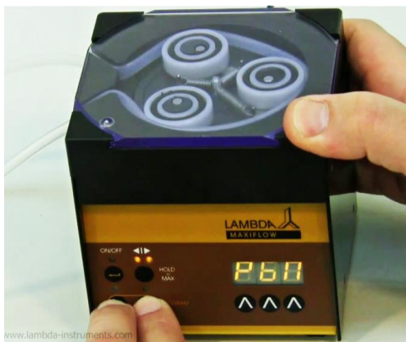
Obrázek 2-1 Stiskněte současně tlačítka REMOTE a RUN dokud se nezobrazí na displeji "PGM".
