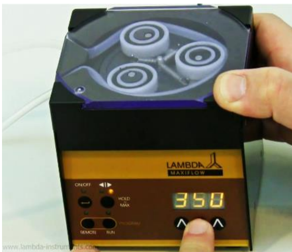
Obrázek 2-5 Pomocí tlačítek \uparrow\uparrow\uparrow pod displejem nastavte požadovanou hodnotu průtoku pro první krok programu (od 0 do 999, což odpovídá 0 až 100 % rychlosti otáčení motoru).
