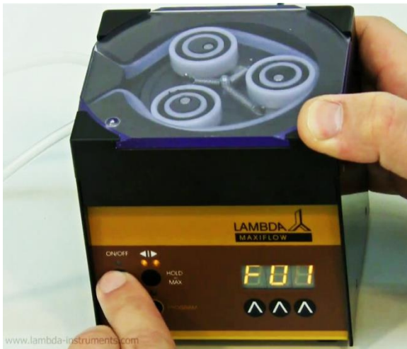
Obrázek 2-3 Stiskněte tlačítko ON/OFF . Na displeji se zobrazí na krátkou dobu označení "F01" (Flow = průtok) a následně můžeme nastavit požadovanou hodnotu průtoku (rychlosti otáčení).
