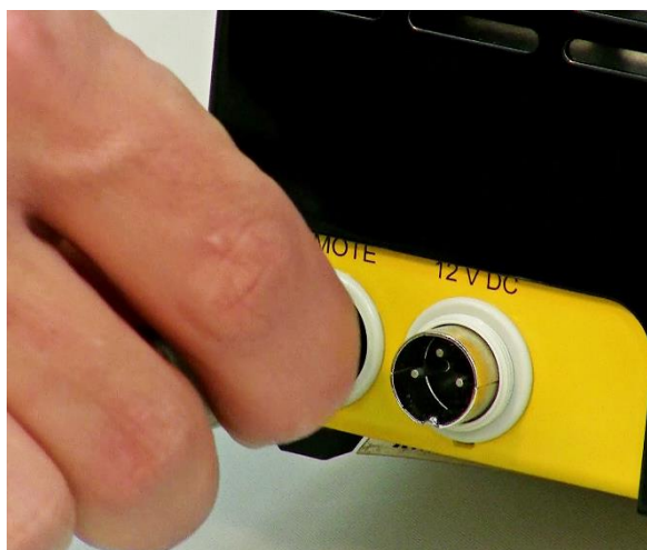
Obrázek 4-1 dálkové ovládání pumpy zapojte 8-pólový kabel dálkového ovládání do konektoru "Remote" na zadní straně peristaltické pumpy.
