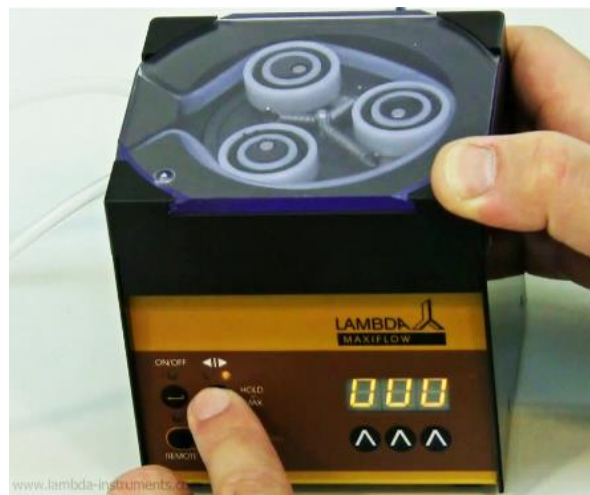
Obrázek 2-10 Zvolte si směr otáčení čerpadla pomocí směrového tlačítka ◀ pro následující průtok (rychlost otáčení).
