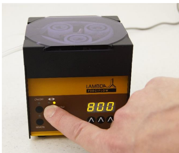
Obrázek 1-14 Svítící LED dioda pod symbolem |▶ představuje rotaci proti směru hodinových ručiček.
